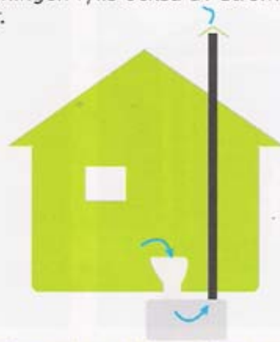
I ett luktfritt utedass cirkulerar luften ut via toalettstolen.
